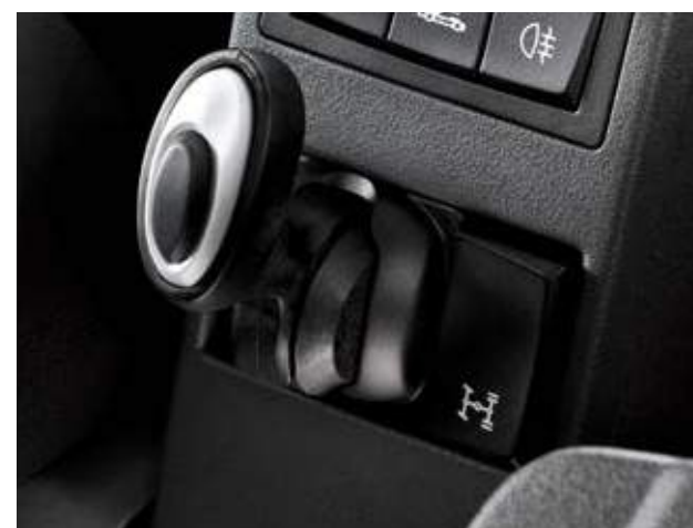
EENVOUDIG IN- EN UITSCHAKELLEN VAN SYSTEEM met een knop op het dashboard, bij een rijsnelheid tussen 0 en 25 km/h.
