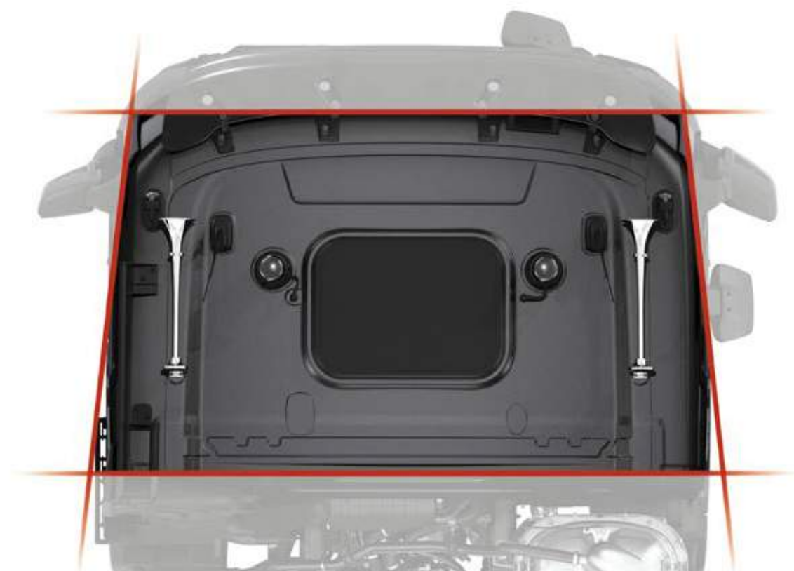
TRAPEZIUMVORMIGE CABINE voor een verbeterde luchtgeleiding en aerodynamica.
