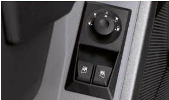
BEDIENING VAN DE ZIJRUITEN EN ACHTERUITKIJKSPIEGELS Ruiten met impulsbediening en elektrisch verstelbare hoofdspiegels en groothoekspiegels.
