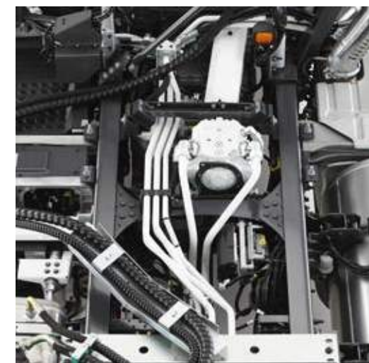
HYDRAULISCHE POMP aangedreven via de motor PTO (PAM).
