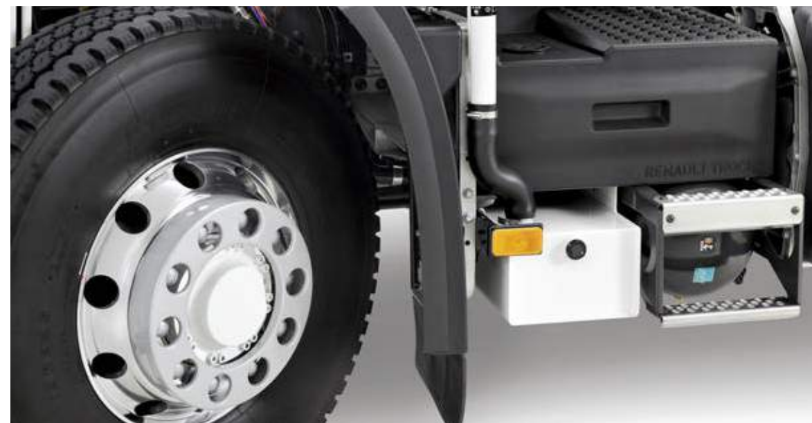
OLIETANK GEMONTEERD ONDER DE ACCUBAK voor meer vrije ruimte aan het chassis.
