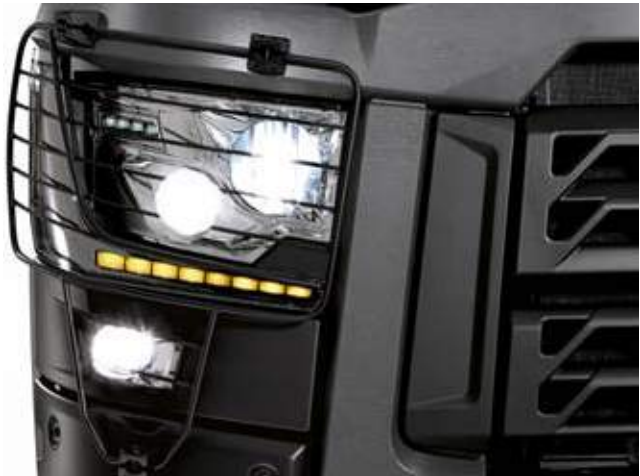
STANDAARD BESCHERMROOSTERS VOOR DE KOPLAMPEN en standaard komlampglas van polycarbonaat optimale bescherming tegen lampschade.
