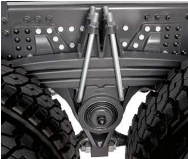
PARABOOL OF LUCHTGEVEERDE ACHTERAS OPHANGING 21 t parabolisch met 3 veerbladen, 26 t parabolisch met 3 veerbladen, 21 t 2x2 luchtbalgen of 26 t 2x4 luchtbalgen.
