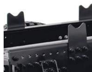
SCHETSPLATEN EN MONTAGECONSOLES AAN HET CHASSIS om de carrosseriewerkzaamheden te vereenvoudigen.
