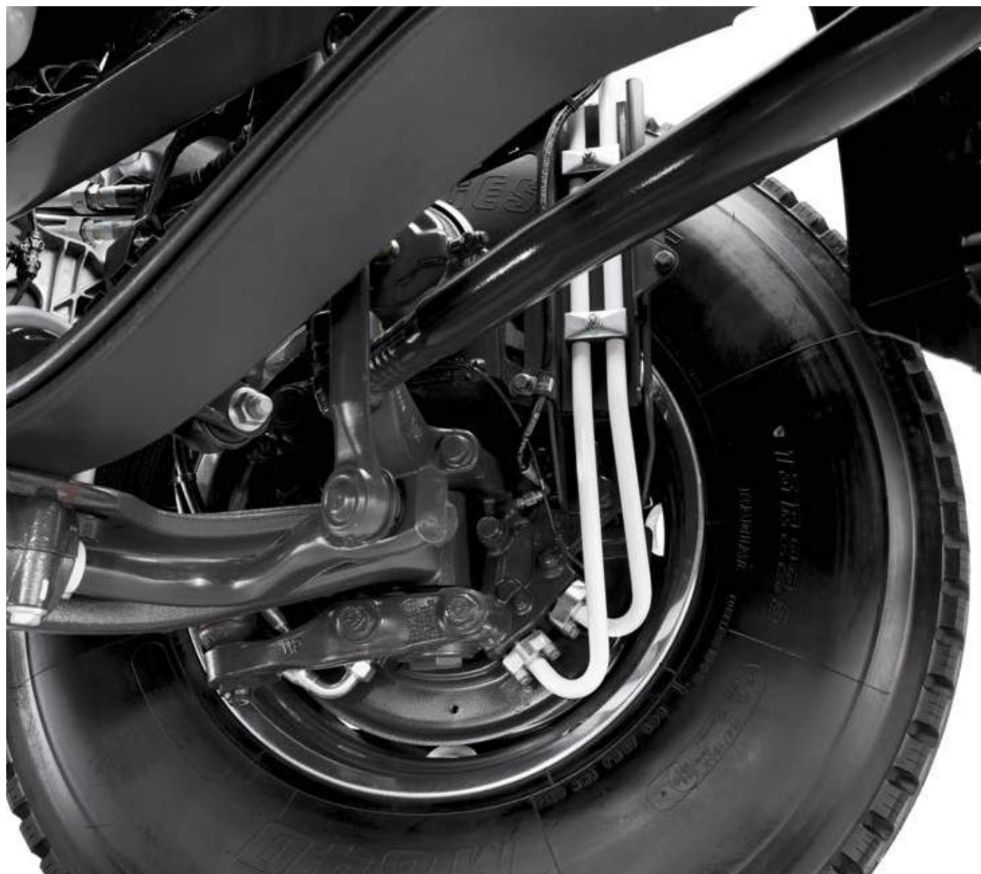
VOORAS UITGERUST MET 2 HYDRAULISCHE WIELMOTOREN met een aandrijfvermogen van 41 kW per motor.
