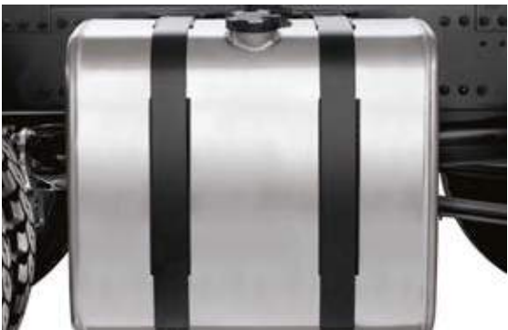
ALUMINIUM BRANDSTOFTANK voor gewichtsbesparing tot 50% in vergelijking met staal.
