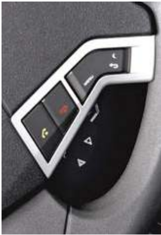
BEDIENING AAN HET STUURWIEL voor de telefoon en om in het menu te navigeren.
