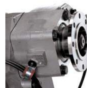
PTO om de opbouw of installatie aan te drijven, stilstaand of al rijdend.
