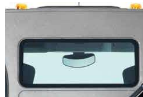
ACHTERRUIT voor een eenvoudigere hantering van de uitrusting (kipper, afsleepvoertuig, etc.).
