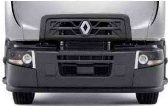
KUNSTSTOF BUMPER (D WIDE) bestaat standaard uit drie delen.
