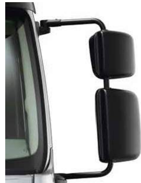
SPECIFIEKE ACHTERUITKIJKSPIEGELS aangepast aan de verschillende opbouwbreedtes met versterkte steunen (minimale trillingen).
