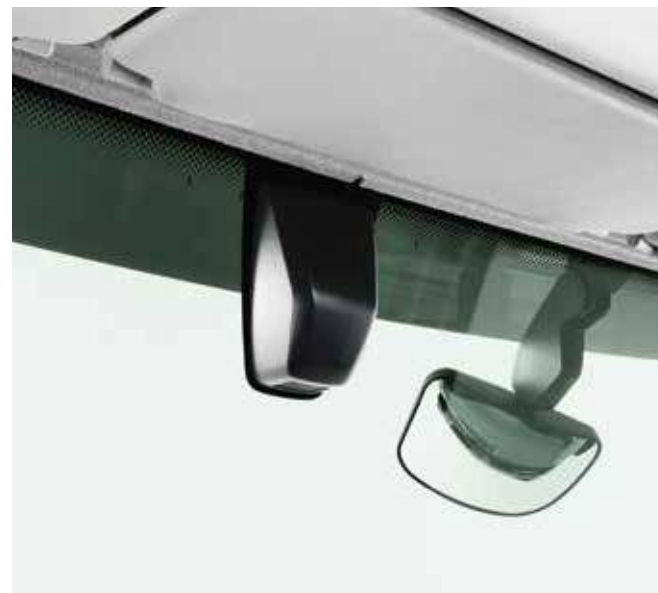
CAMERA voor het Lane Departure Warning System (LDWS) en Advanced Emergency Braking System (AEBS).
