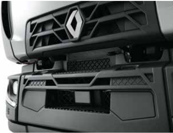
OPSTAPTREDEN IN DE VOORBUMPER voorzien van antislip om het onderhoud aan de voorruit te vergemakkelijken.
