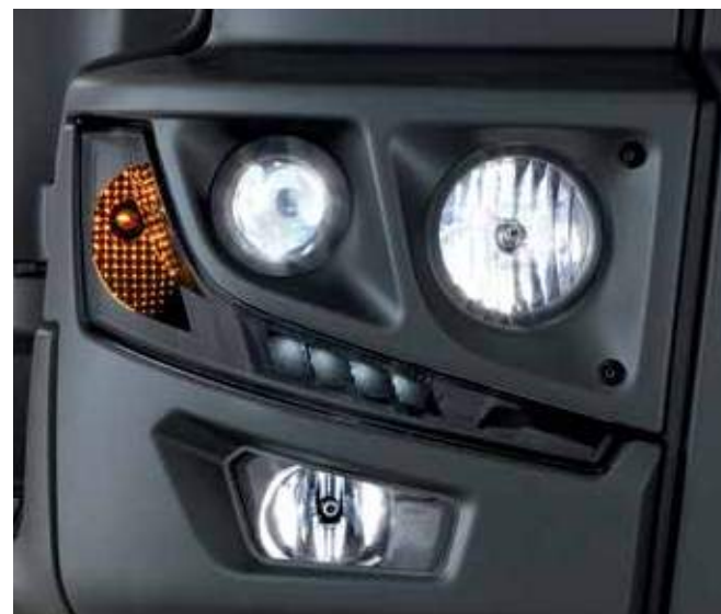
NIEUWE KOPLAMPEN uitgerust met dagrijverlichting middels 4 leds.
