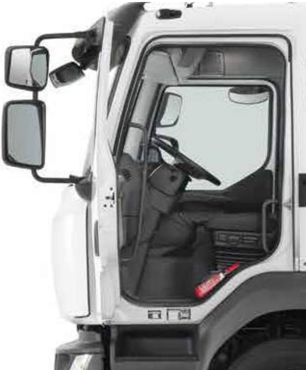
OPENING TOT 90° voor een ruime toegang tot de cabine.
