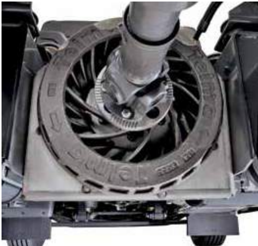
ELEKTRISCHE RETARDER IN DE AANDRIJFLIJN en hydraulische retarder op de versnellingsbak.
