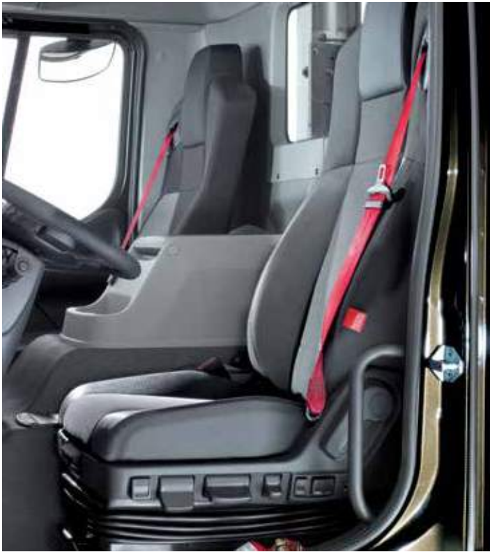
STOLEN MET VERWARMING EN LUCHTVERING geveerd en met verstelbare zij- en lendesteunen.
