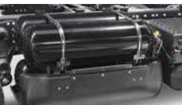
STALEN CNG TANK VOOR GECOMPRIEED AARDGAS (COMPRESSED NATURAL GAS) met een brandstofcapaciteit tot en met 120 kg.
