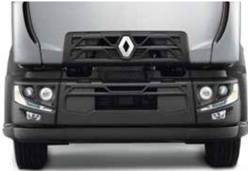
KUNSTSTOF BUMPER (D CAB 2.1 M) bestaat standaard uit drie delen.
