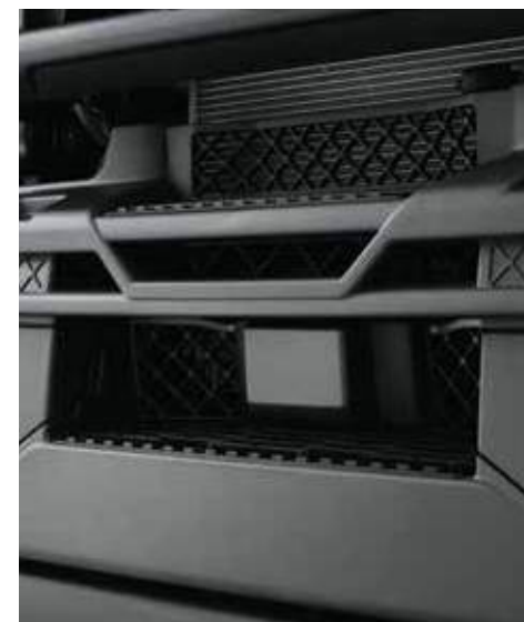
DETECTIERADAR voor het Advanced Emergency Braking System (AEBS).
