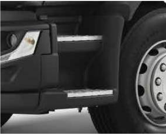
CABINE INSTAP MET 2 TREDEN waarbij de bovenste trede 80 mm inspringt ten opzichte van de onderste, voor comfortabel instappen.
