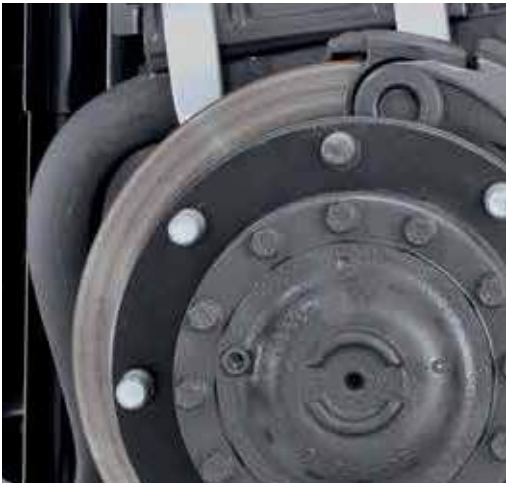
SCHIJFREMMEN voor een remvertraging van 7 m/s 2 in geval van een noodstop (de norm is 4,5 m/s 2 ).
