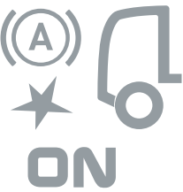
ADVANCED EMERGENCY BRAKING SYSTEM (AEBS) waarschuwing bij een eventuele botsing en vervolgens afremmen en totaal stilzetten van het voertuig, zonder enig ingrijpen door de chauffeur.
