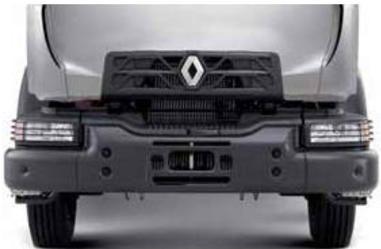
100% STALEN BUMPER (D CAB 2.1 M) voor zware toepassingen.
