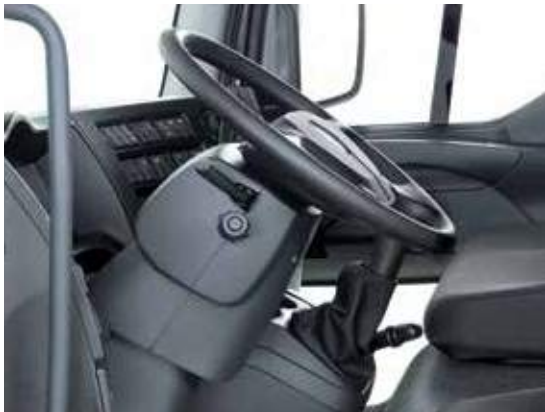
VERSTELBAAR STUUR luchtbediend en in twee richtingen verstelbaar.
