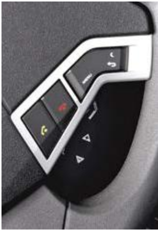
BEDIENING AAN HET STUUR voor de telefoon en om in het menu te navigeren.
