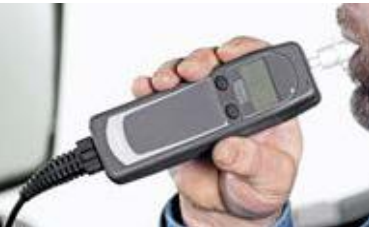
ALCOHOLSLLOT om het alcoholpromillage in het bloed van de chauffeur te controleren voordat het voertuig wordt gestart.
