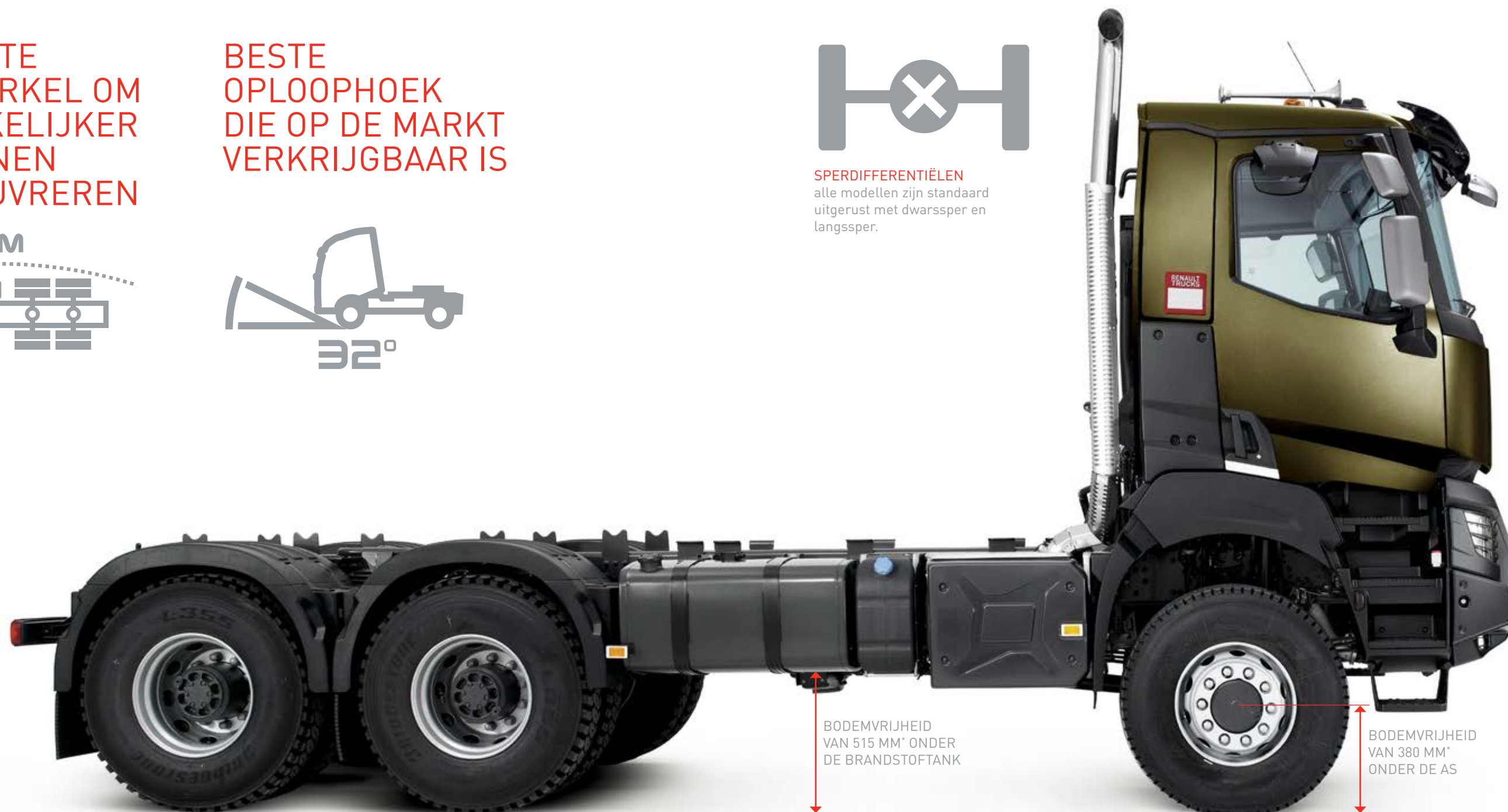
AANGEDREVEN TANDEMAS MET DUBBELE REDUCTIE voor een groter aandrijfvermogen in lastig terrein.
