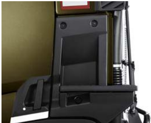
OPSTAP AAN DE ZIJKANT VAN DE CABINE voor een eenvoudige toegang tot de kraan of kipper.
