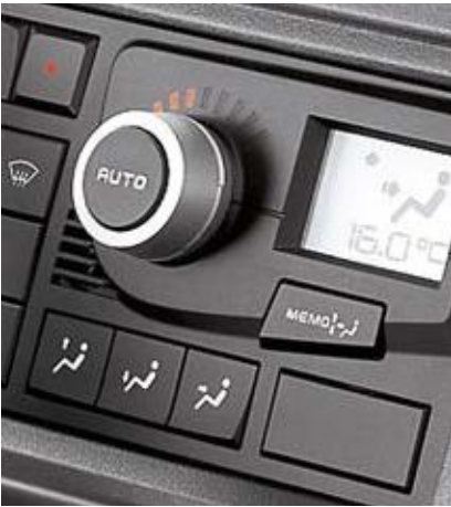
AUTOMATISCHE AIRCONDITIONING EN ONTDOOIING van de zijruiten, de voorruit en de achteruitkijkspiegels.
