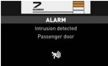
ANTI-INBRAAKALARM dat de chauffeur informeert als de deuren worden geopend.
