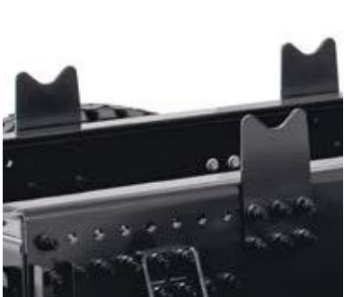
BEVESTIGINGSCONSOLES EN SCHETSPLATEN AAN HET CHASSIS om de carrosseriewerkzaamheden te vergemakkelijken.
