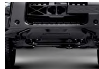
BESCHERMINGSPLAAT onder de radiator en het oliecarter.
