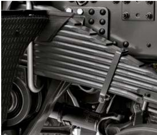
HALF-ELLIPTISCHE OF PARABOLISCHE VEERBLADEN 26 t parabolisch 3 veerbladen, 32 t half-elliptisch 11 veerbladen, 32 t Xtrem parabolisch 4 veerbladen.
