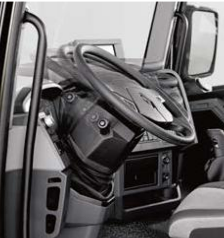
IN DRIE RICHTINGEN VERSTELBAAR STUUR: afstand, hoogte en hoek.
