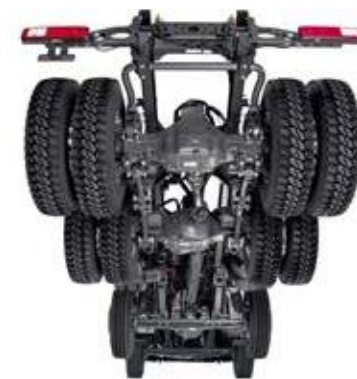
AANGEDREVEN TANDEMAS MET DUBBELE REDUCTIE voor een groter aandrijfvermogen in lastig terrein.
