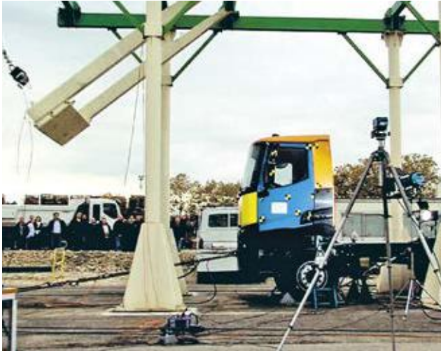
FONT IMPACT TEST om de sterkte van de cabine bij een frontale botsing te bepalen.
