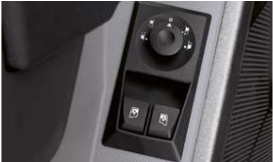
BEDIENING VAN DE ZIJRUITEN EN ACHTERUITKIJKSPIEGELS Ruiten met impulsbediening en elektrisch verstelbare hoofdspiegels en groothoekspiegels.
