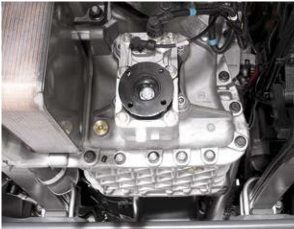
OPTIDRIVER XTREM Speciaal ontworpen voor gebruik in de mijnbouw, steengroeven en voor zwaar grondverzet: heeft een as met zes segmentveranderingen in plaats van vier, specifieke tandwielen en een schakelprogramma voor versnellingen dat zich aanpast aan de belading van het voertuig.
