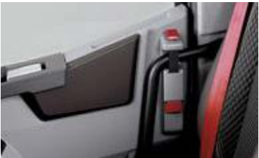
MECHANISCHE ANTI-INBRAAK VERGREDELING "DOORLOCK" voor een extra vergrendeling van de portieren van binnenuit.
